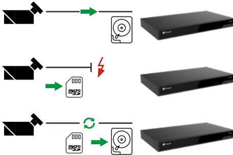
Die Funktion ANR dient zur unterbrechungsfreien Aufzeichnung, wenn die Verbindung zur Kamera unterbrochen wird.
