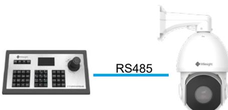
Die Kamera verfügt über eine RS485 Schnittstelle. So können Sie die Kamera mit einem RS485-Controller über RS485 mit PELCO-D Protokoll steuern.
