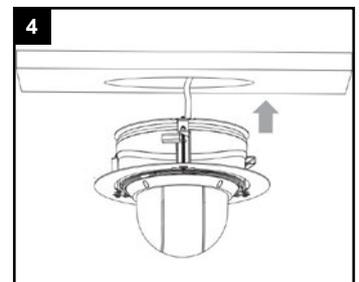
Kamera mit Deckeneinbauhalter in die Decke einsetzen.
