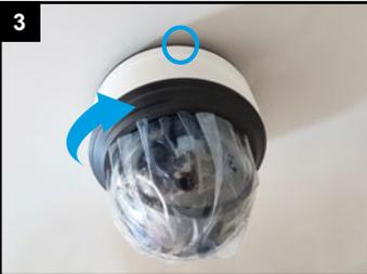
Kamera an Montageplatte drehen und Feststellschraube festziehen.
