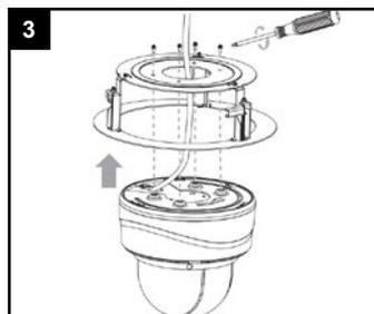
Kamera einsetzen und festschrauben.
