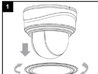
Abdeckungs-Ring durch drehen lösen.
