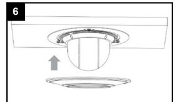
Abdeckungs-Ring aufsetzen und durch drehen befestigen.
