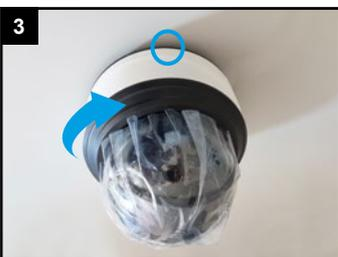
Kamera an Montageplatte drehen und Feststellschraube festziehen.
