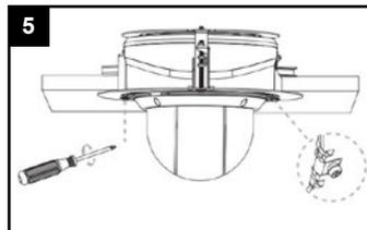
Deckeneinbauhalter in die Decke befestigen.
