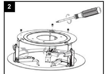
Klammern des Deckeneinbauhalters öffnen und Schrauben eindrehen.
