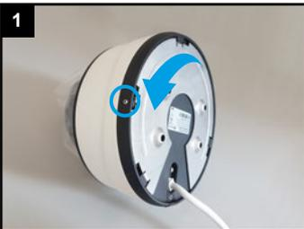
Feststellschraube lösen und Montageplatte abnehmen.
