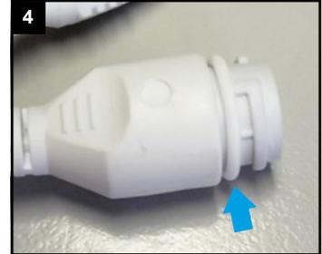
O-Ring auf Netzwerkbuchse am Kabel der Kamera setzen.
