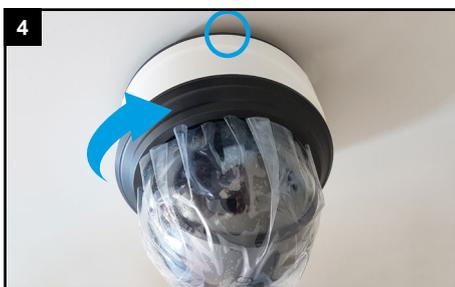
Drehen Sie die Kamera an der Montageplatte, bis sie einhakt und ziehen Sie die Feststellschraube wieder an. Überprüfen Sie den Halt der Kamera.
