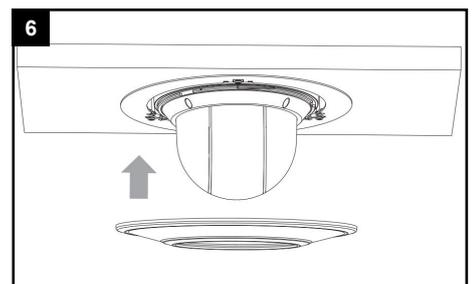
Prüfen Sie den Halt der Kamera und setzen Sie den Abdeckungs-Ring auf.
