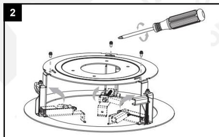
Öffnen Sie die Klammern des Deckeneinbauhalters und ziehen Sie die Schrauben fest.
