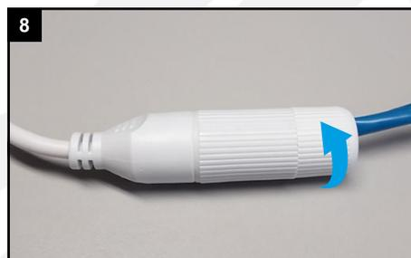
Schrauben Sie die Verschraubung feste an.
