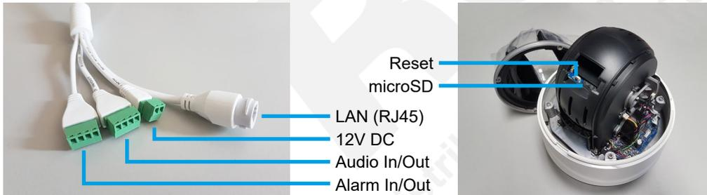
Der MicroSD Kartenslot und die Reset-Taste befinden sich im Gehäuse der Kamera. Hierzu muss die Abdeckung der Kamera, die mit vier Schrauben befestigt ist, entfernt werden.
