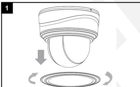
Lösen Sie den schwarzen Abdeckungsring der Kamera durch Drehen.
