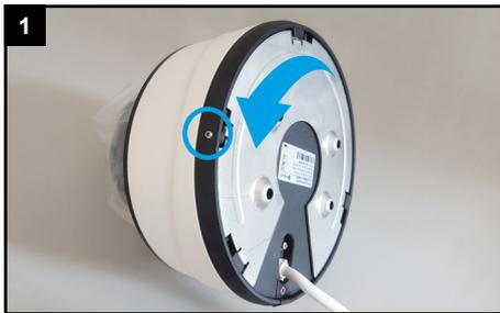
Lösen Sie die Feststellschraube und nehmen Sie die Montageplatte durch Drehung in Pfeilrichtung ab.
