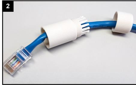
Siehen Sie die Verschraubung und den Schraubbolzen nacheinander über das Kabel, mit dem Sie die Kamera verbinden möchten.
