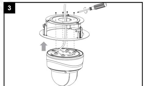
Setzen Sie die Kamera in die Deckeneinbauhalterung und ziehen Sie die Schrauben fest.
