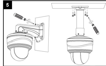
5 Befestigen Sie die Halterung und prüfen Sie den Halt.
