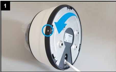
1 Feststellschraube lösen und Montageplatte abnehmen.
