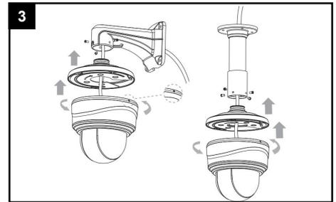
3 Drehen Sie die Kamera an der Montageplatte, bis sie einhakt...
