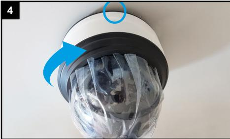
4 ...und ziehen Sie die Feststellschraube wieder an. Überprüfen Sie den Halt der Kamera.
