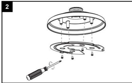
2 Montageplatte an die Decke befestigen und Kabel verbinden, siehe Kapitel [Verkabelung].
