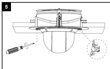
Setzen Sie die Kamera mit dem Deckeneinbauhalter in die Decke und befestigen Sie diesen durch Anziehen der Schrauben.
